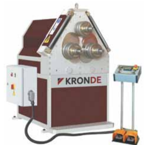
Гидравлический профилегиб KRONDE серии BR 60 Скорость гибки: 6,4 м/мин
