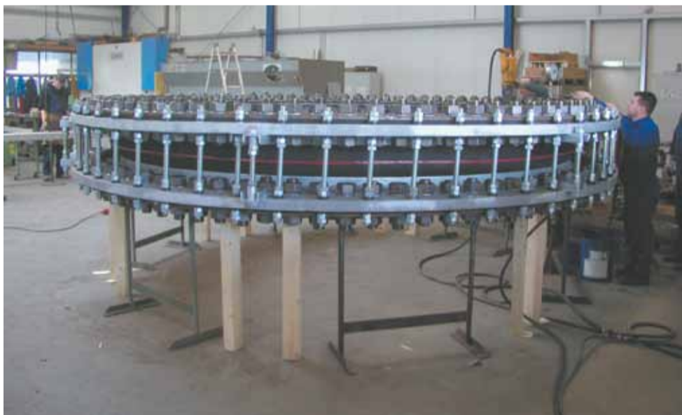
Испытания на прочность резинокордного компенсатора
